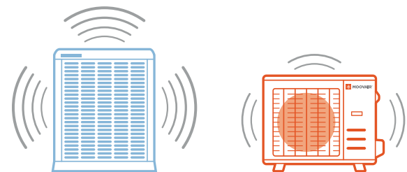
Système central traditionnel : 73 dB(A) Système Central-Moov : 58 dB(A)
